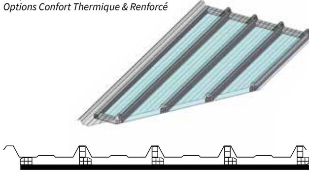
Les options Confort Thermique et Renforcé (TR) combinent l'ajout de renforts longitudinaux en polycarbonate sous chaque nervure avec l'utilisation d'une sous-face en polycarbonate alvéolaire 16 mm
