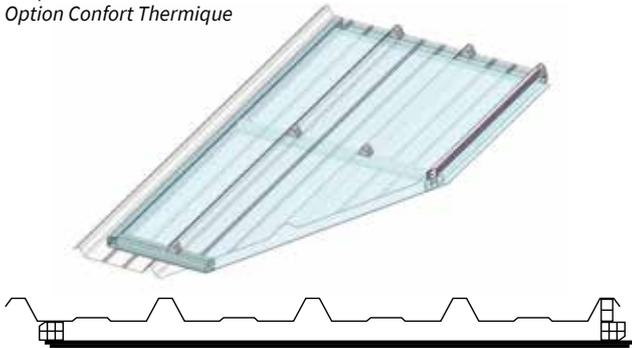
L'option Confort Thermique (T) comprend une sous-face en polycarbonate alvéolaire 16 mm.
