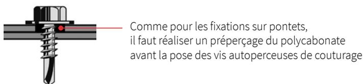
Comme pour les fixations sur pontets, il faut réaliser un préperçage du polycarbonate avant la pose des vis auto-perçuses de couturage
