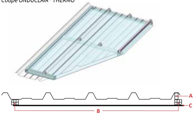
**A :** Renfort longitudinal en polycarbonate sur toute la longueur de la nervure recouverte.
